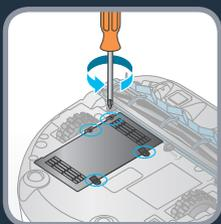
**PT** Com uma chave de fendas, abra a tampa do compartimento da bateria. Retire a bateria do robot.
