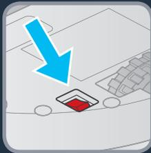
**PT** Vire o robot e ligue o interruptor para a posição de ligado (I). As luzes LED acendem e ficam a piscar no painel do robot durante alguns segundos.
