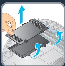
**CS** Šroubovákem odšroubujte víko prostoru pro baterie. Odpojte baterii a vyjměte baterii z robotu.
