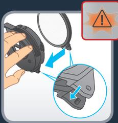
**IT** Il robot non si avvierà se il contenitore della polvere o il filtro non sono installati. In tal caso, la spia di errore rimarrà accesa e nell'applicazione apparirà un messaggio.
