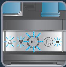
**CS** Otočte robot vzhůru nohama a zapněte hlavní vypínač (I). Na panelu robota budou několik sekund blikat LED kontrolky.
