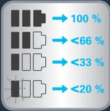
**IT** Indicatore del livello di carica della batteria e dell'autonomia
