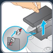
**RO** Cu ajutorul unei șurubelnițe, deschideți capacele compartimentului de baterii. Deconectați bateria și scoateți bateria din robot.
